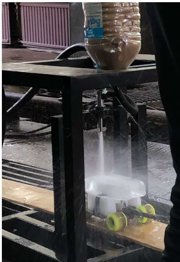
Рис. 3. Стенд в процессе гидроабразивного разрушения льда
