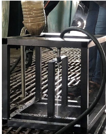
Рис. 2. Экспериментальный стенд во время наладки гидроабразивной установки
